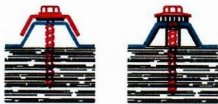
Profil 70/18 Befestigung Dach
